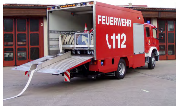
Gerätewagen Logistik mit Komponente Wasserförderung, Baujahr 2006
